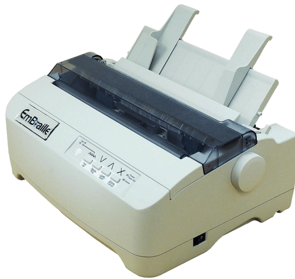
Figura 35: Impressora braille em folha de papel A4. Fonte: http://viewplus.com/product/vp-embraille/ . Consultado em 6 de junho de 2016.
