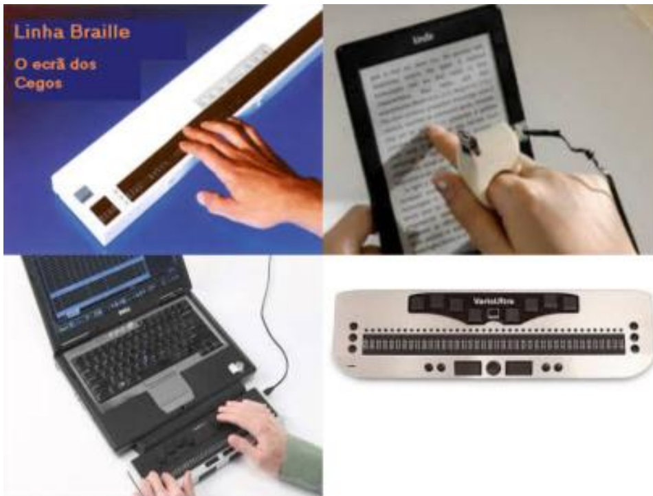
Figura 36: Linhas braille e sensor de leitura com o dedo na tela do computador. 36
